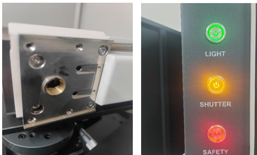
图4-11 左图：X射线管出口快门；右图：中间为快门控制按键
