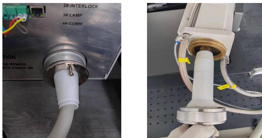
图4-4 左图：高压线和高压源的连接；右图：高压线和管套的连接
