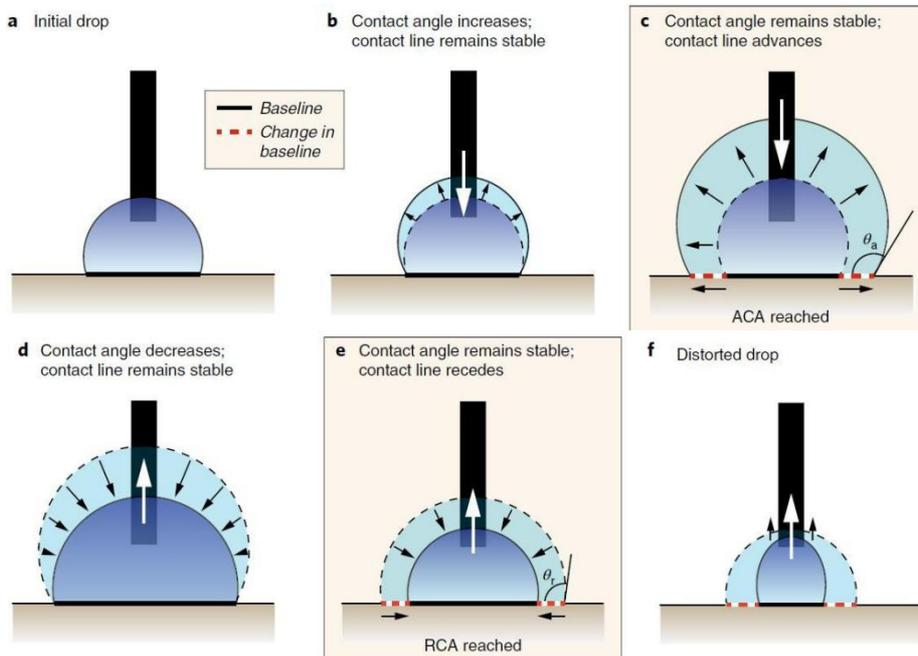
实验前在样品上准备一小滴液滴如 3 微升或 5 微升，将针尖插入液滴中（上图a）。持续扩大液滴体积（上图b）。液滴在扩张的过程中，读出的每一张图片的接触角都是**前进角**（上图c）。
