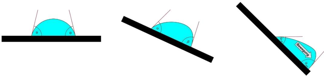
仪器样品台上可以安装一个可以转动的倾斜台。台面在旋转过程中，如果液滴恰好开始向一个方向滚动，斜面转过的角度就是滚动角。
