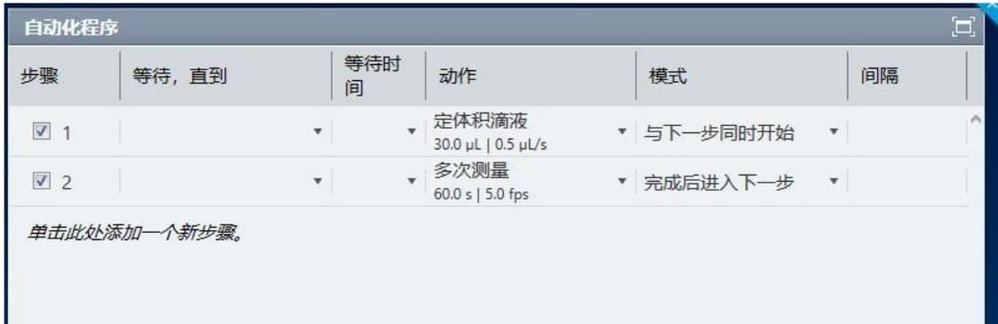
后退角：第一行编写回吸，设定回吸速度如 20-50 微升，回吸速度如 0.1 或 0.5 微升/秒。第二行编写多次测量，设定测量时间和拍照速度。并且将第一行的模式改为与下一行同时开始。
