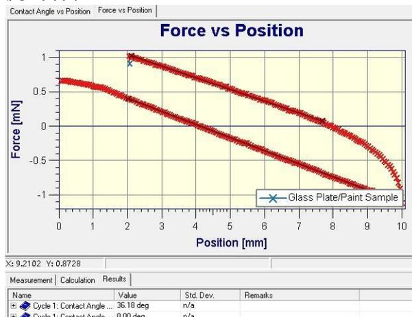
如图，使用鼠标调整拟合曲线的端点，使用线性较好的一段数据做接触角的计算。
