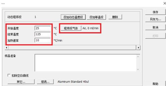
点击“程序段气体”选择合适的气氛(仅提供空气和氮气)和流量(建议 50 mL/min)
