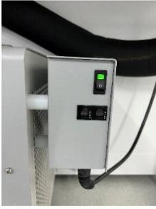
**第五步：关制冷机**（最后一个样品测试完成后，温度降至 200 度以下，关闭机械制冷，发送干燥实验）
