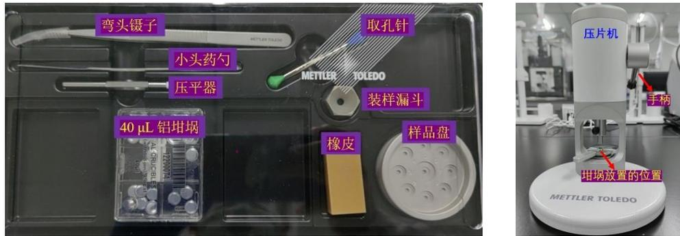
1. 样品量：有机物样品: 5–10 mg；无机物样品: 10–30 mg；具有强放热效应的样品 0.5–1 mg。原则是不超过坩埚体积的 1/2.
