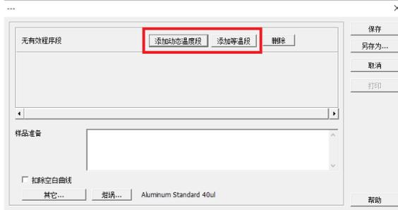
如下图所示， 进行设置（升温速率建议 10–20 °C/min）
